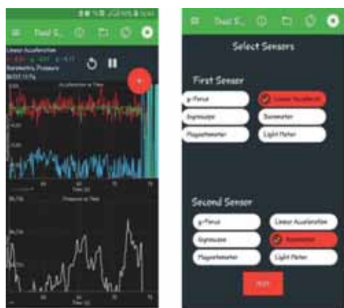
▲ شکل ۲۳. اولین شکل از سمت راست، نمایی از صفحه انتخاب سنسور و دومین شکل رسم همزمان نمودارهای انتخابی توسط کاربر
